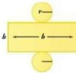
El desarrollo de un cilindro corresponde a dos círculos de igual radio y a un rectángulo cuyo ancho es igual a la altura del cilindro, y cuya base es igual a la longitud de la circunferencia de la base. A partir del desarrollo del cilindro se puede calcular su área lateral, área total y volumen.
